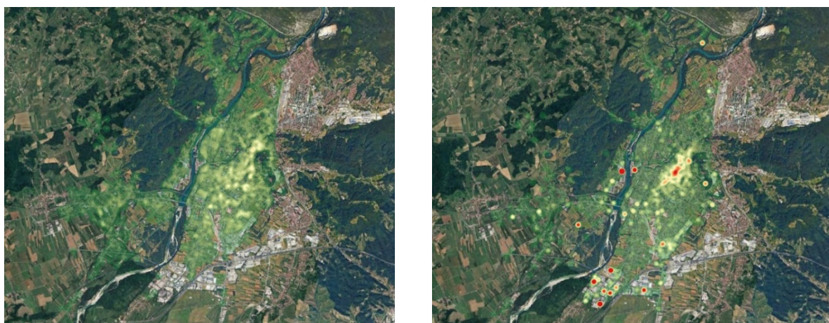
Figura 5 - Distribuzione della potenza impegnata del carico domestico (a sinistra) e non domestico (a destra) a Gorizia.
